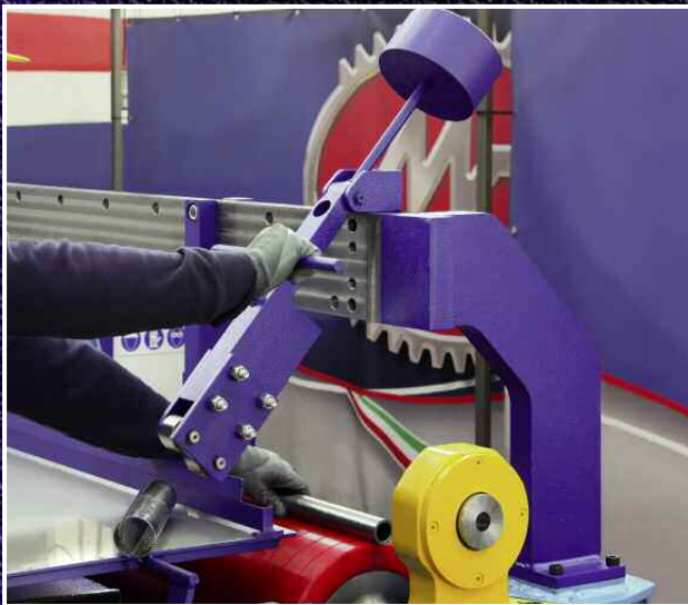
• Supporto centrale speciale per piccoli diametri e virole corte • Special central support for small diameters and short pipes • Soporte vertical especial para diámetros pequeños y virolas cortas • Support central special pour petites diamètres et petites viroles
