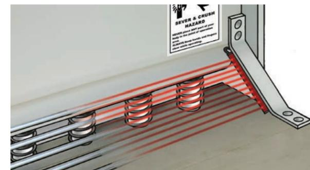
Para mejorar la seguridad, y permitir al operador colocar piezas más pequeñas en la posición de corte, una cortina de luz puede ser adquirida para reemplazar la guarda mecánica para los dedos.
