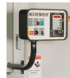
Ajuste motorizado de claro entre cuchillas incluido en modelos 650014 y mayores, y opcional en modelos 62506 a 650012.
