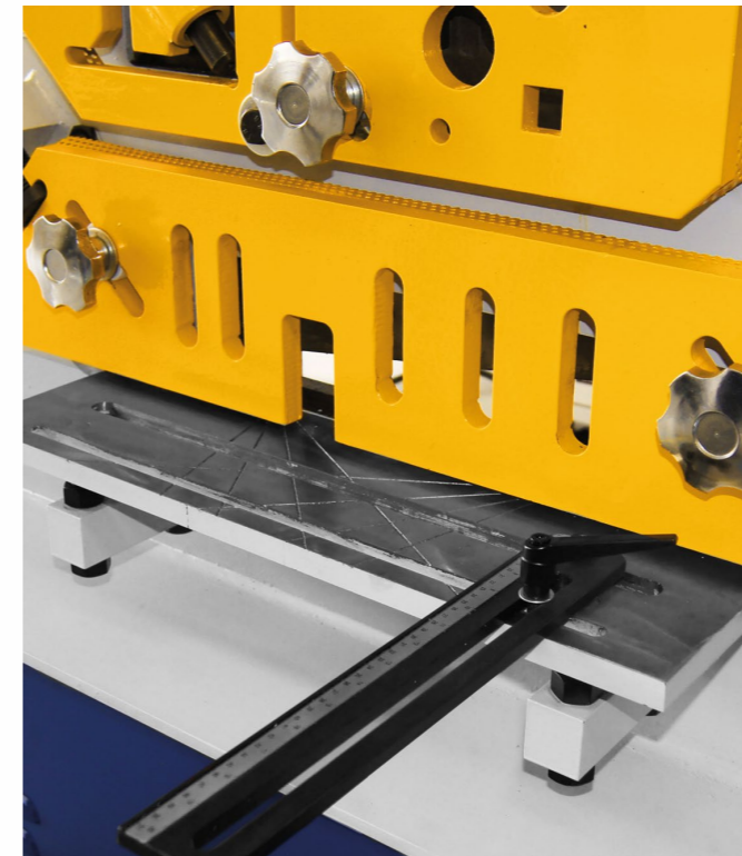
Guía para corte de placa con regla graduada ajustable
