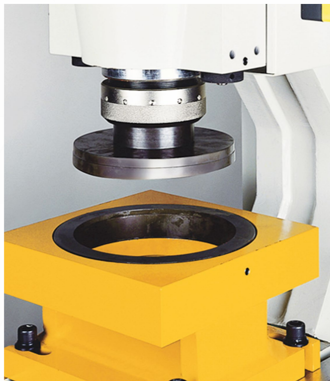
Punzonado en diámetros de hasta 4-3/4"
