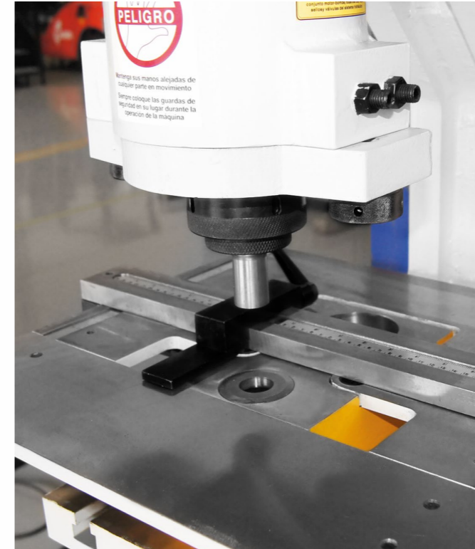
Mesa para punzonado con guías graduadas, regla y tope ajustable
