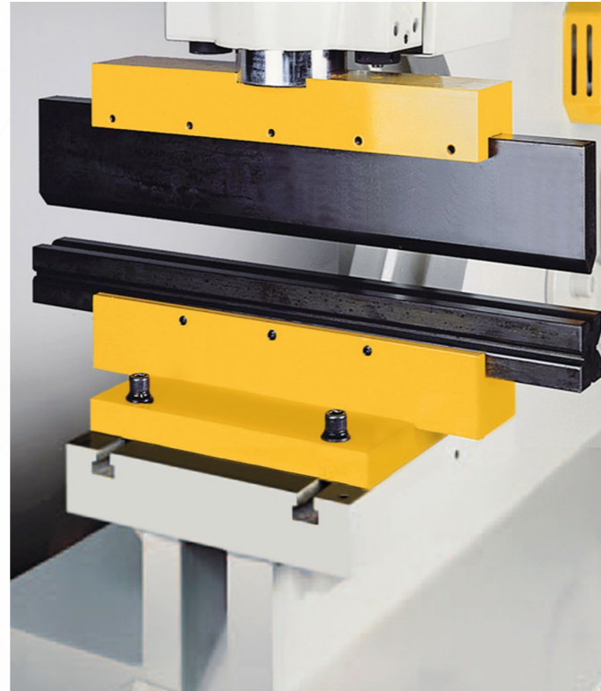
Herramental de doblado de hasta 19-5/8" de largo
