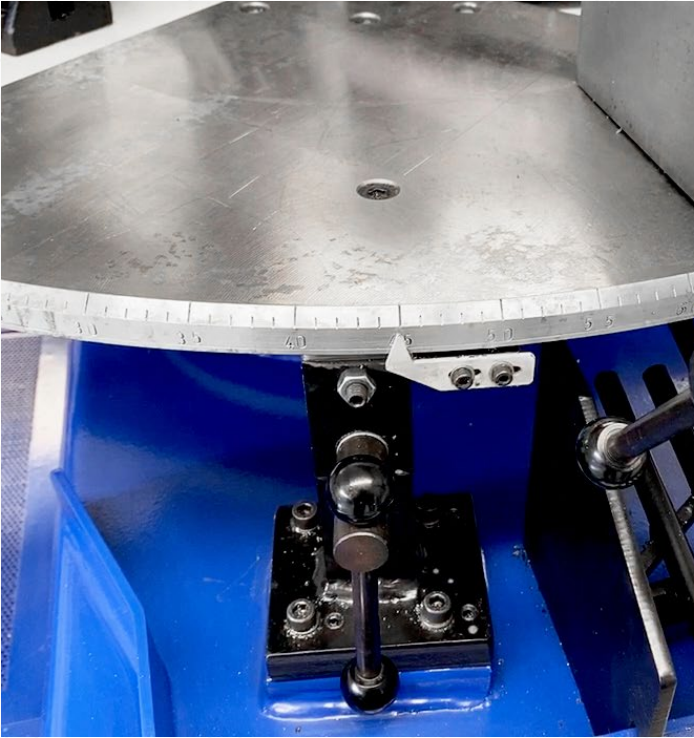
Giro Manual del Cabezal para Corte en Grados (Der./Izq.)
