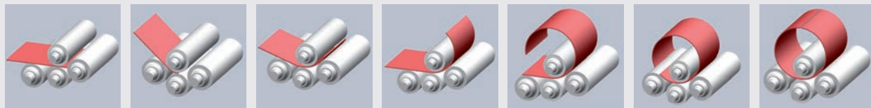
Fasi principali di calandratura 4 rulli / Main phases of 4-roll plate bending / Wichtigste Arbeitsabläufe des Dreiwalzen-Biegeprozesses
