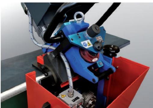
**1 STRUTTURA** Struttura in acciaio e fusione di alluminio. Piastra di appoggio temprata con rulli di scorrimento. Trascinamento motorizzato con due ruote in poliuretano (90 shore). Carrello di supporto regolabile in altezza e completo di protezione e cassetto raccogli trucioli completo di ruote girevoli con freno. Possibilità di lavorare con carrello sollevato in presenza di pavimentazione irregolare. Possibile lavorare anche senza il carrello di supporto.
