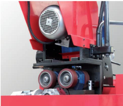
**I** Innovativo gruppo di trascinamento con regolazione automatica di serraggio della lamiera, che consente alle quattro ruote una perfetta e potente aderenza, mantenendo sempre la macchina ad un rigido contatto con la lamiera.
