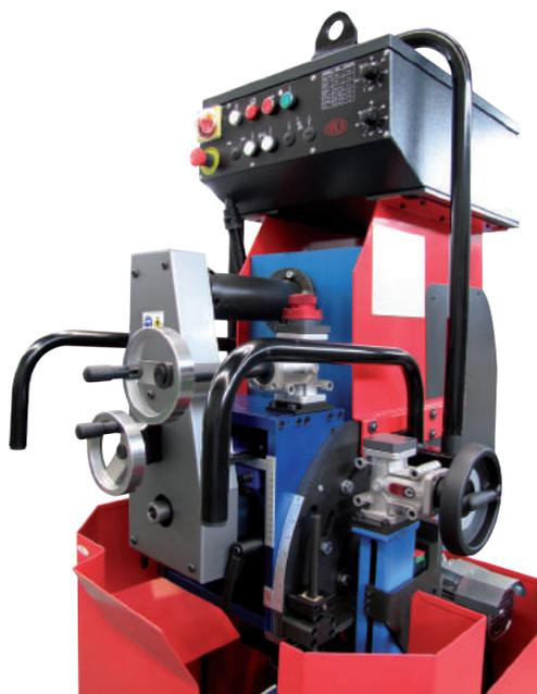
**I STRUTTURA** Struttura in acciaio e fusione di alluminio. Piastra di appoggio temprata con rulli di scorrimento. Trascinamento motorizzato con quattro ruote in poliuretano. Carrello di supporto regolabile in altezza e completo di protezione e cassetto raccogli trucioli completo di ruote girevoli con freno. Possibilità di lavorare con carrello sollevato in presenza di pavimentazione irregolare.
