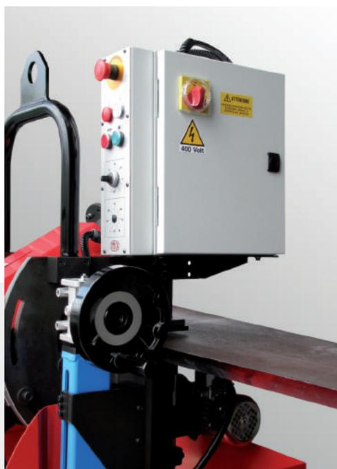
**I STRUTTURA** Struttura in acciaio e fusione di alluminio. Piastra di appoggio temprata con rulli di scorrimento. Trascinamento motorizzato con due ruote in poliuretano (90 shore). Carrello di supporto regolabile in altezza e completo di protezione e cassetto raccogli trucioli completo di ruote girevoli con freno. Possibilità di lavorare con carrello sollevato in presenza di pavimentazione irregolare. Possibile lavorare anche senza il carrello di supporto.
