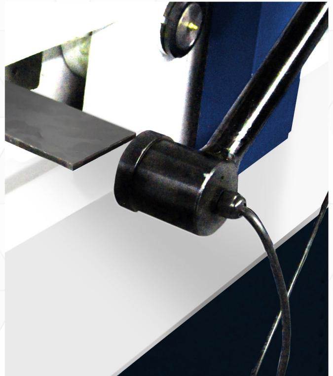
Tope trasero electrónico ajustable para cortes repetitivos en todas las estaciones de corte
