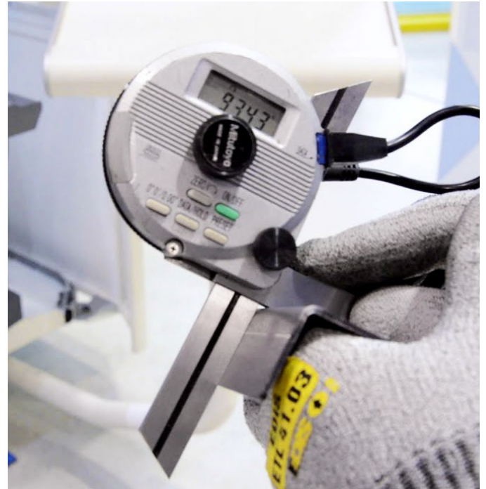
Medidor de ángulos electrónico con conexión Bluetooth. Se mide el ángulo de la primera pieza y el CNC automáticamente ajusta la carrera.
