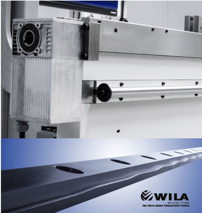
Control de corona con ajuste automático por CNC. WILA, Holanda.
