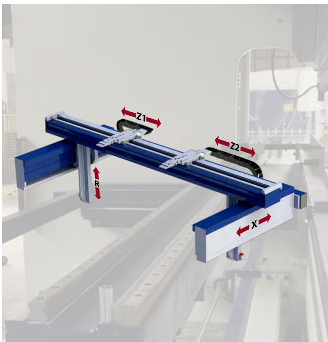
Tope trasero CNC con ejes X, R y Z1/Z2.
