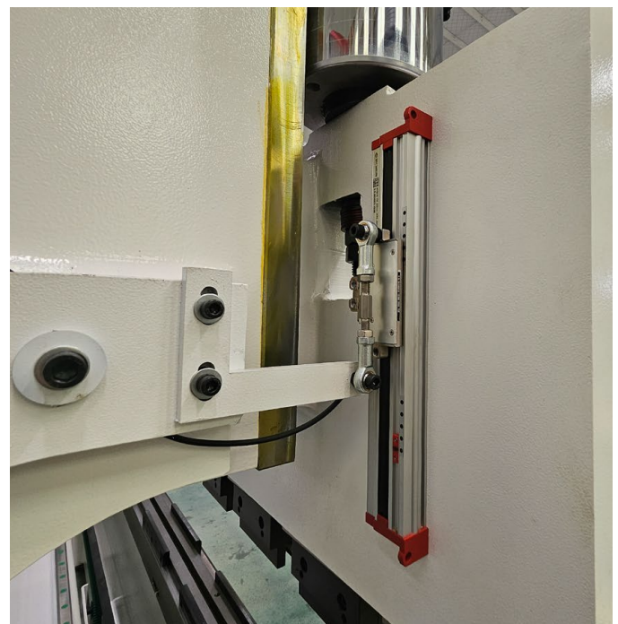
Escalas lineales ópticas de alta, Givi, Italia. precisión: \pm 0.0002'' ( \pm 0.005 mm).
