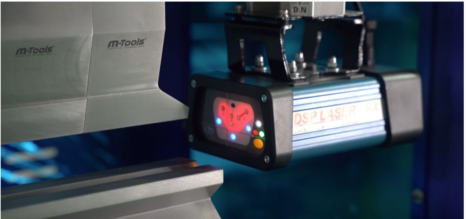
Dispositivo láser de seguridad frontal para el área de doblez. Nuova Elettronica, Italia.
