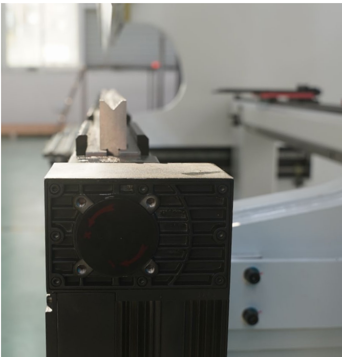
Control de corona motorizado con ajuste automático CNC. Compensa la deflexión de la cama, garantizando uniformidad en el ángulo de doblez a todo lo largo, sin necesidad de calzar.
