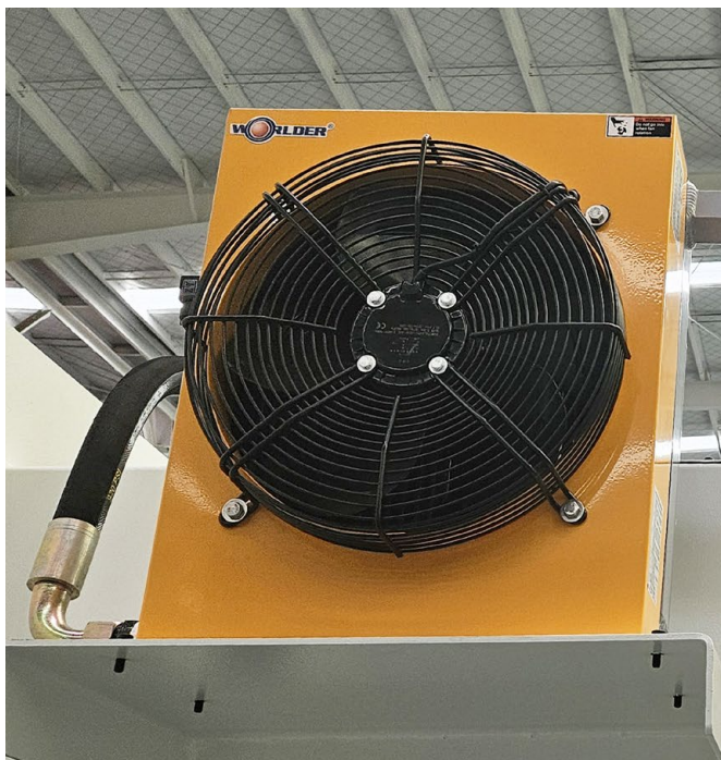
Enfriador de aceite para el sistema hidráulico. Tipo radiador.
