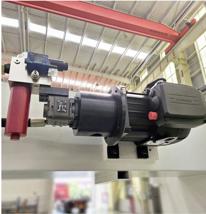
Motor principal servo en vez de motor convencional. Ahorra 50% de energía. El motor solo opera cuando se aprieta el pedal.
