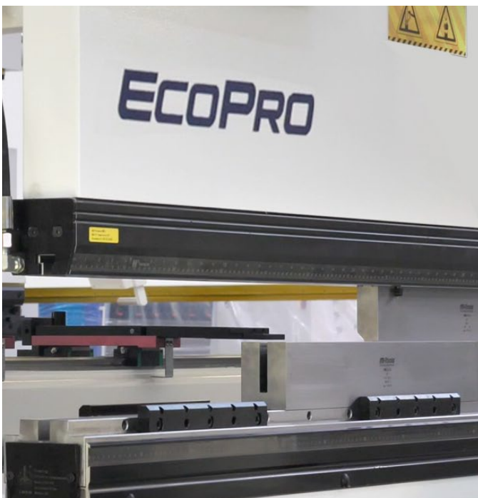
Portaherramientas superior con sujeción hidráulica tipo Wila American. Acepta herramientas tipo Wila American con botones de sujeción, o tipo americano.
