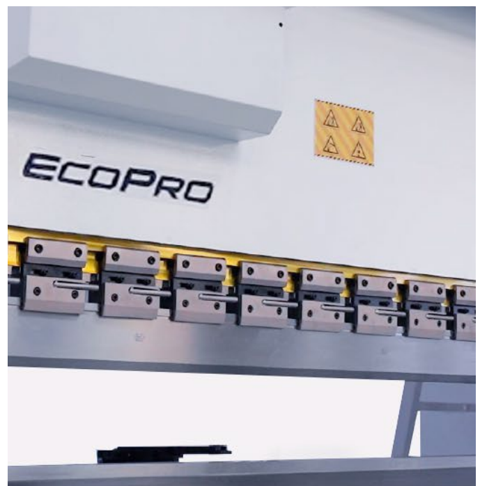
Portaherramientas superior tipo europeo con sujeción manual y carga lateral sin costo adicional. (1) Una herramienta superior de alta precisión tipo europeo.
