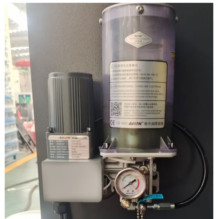
Lubricación centralizada automática para las guías de la cortina.
