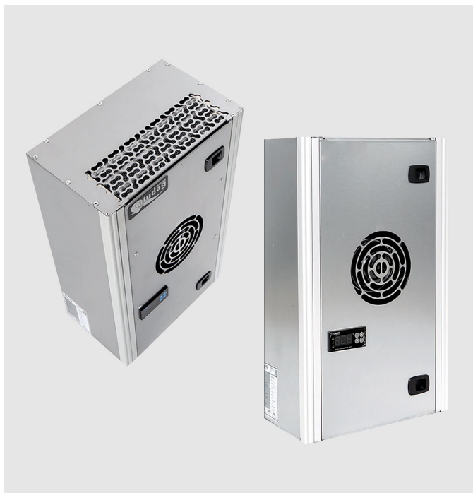
Aire acondicionado para el gabinete eléctrico. Se recomienda para temperaturas ambientales mayores a 35° C o cuando se utilizan más de 4 ejes.
