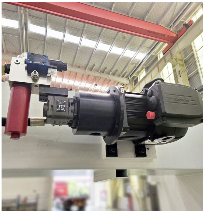
Motor principal servo en vez de motor convencional. Hasta 50% en ahorro de energía.
