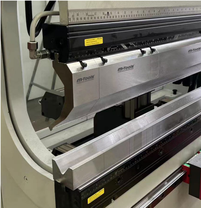
Portaherramientas superior hidráulico American Style. y control de corona con ajuste automático CNC.
