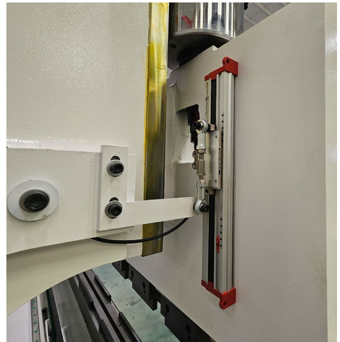
Escalas lineales ópticas de alta precisión: \pm 0.0002'' ( \pm 0.005 mm). Givi, Italia.
