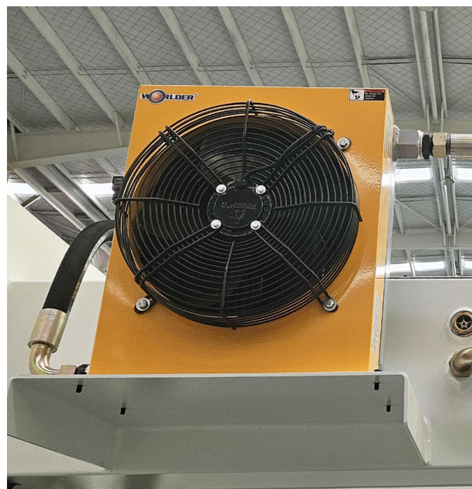
Enfriador de aceite tipo radiador.
