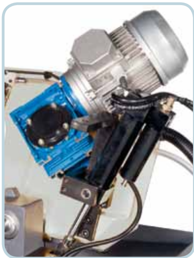
Bajada hidráulica Hydraulic descent
