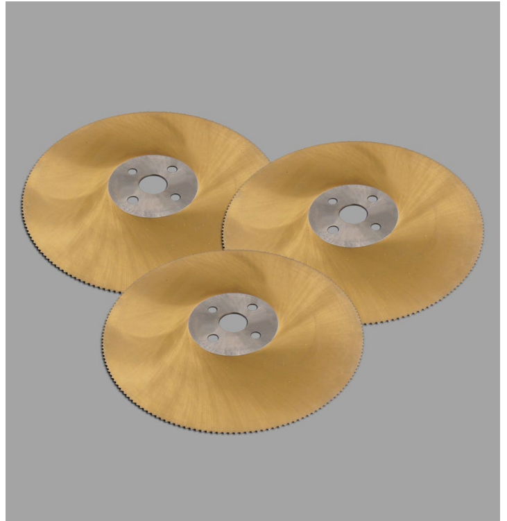
Discos de corte en acero de alta velocidad (HSS), tratados térmicamente y endurecidos a 63-65 Rockwell C. (Se incluye un disco).
