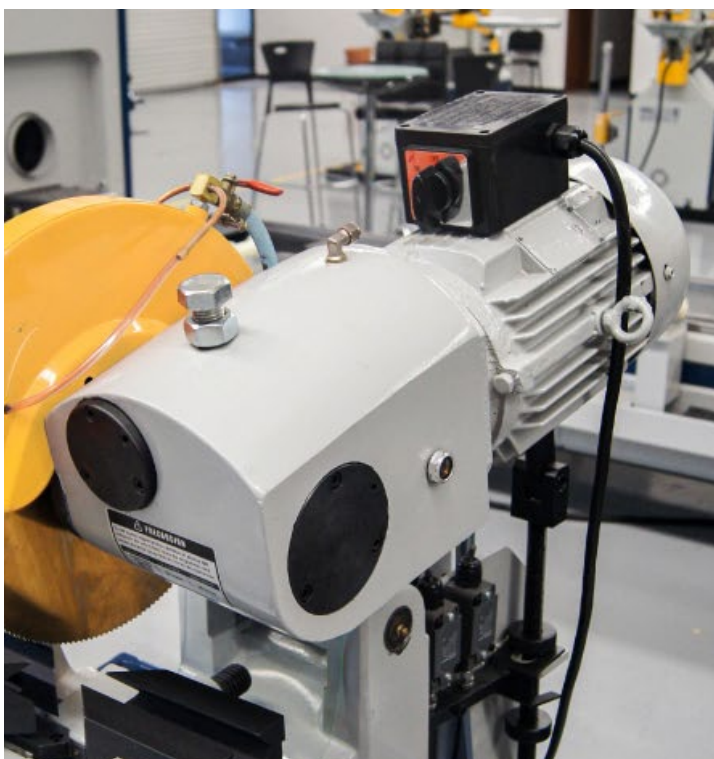
Motor de hasta 7.4 hp con dos velocidades (alta y baja) y caja de engranes sumergida en aceite.
