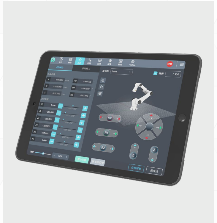
Control (Teach pendant) inalámbrico tipo tableta.
