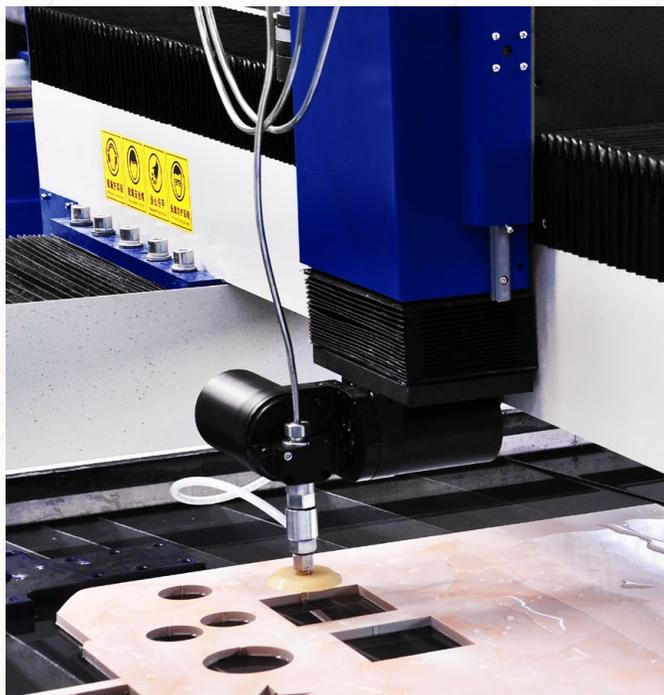
Cabezal AB para lograr cortes sin inclinación
