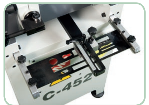
Pisadores y refrigeración manual (C-452-M) Manual pistons and refrigeration (C-452-M)
