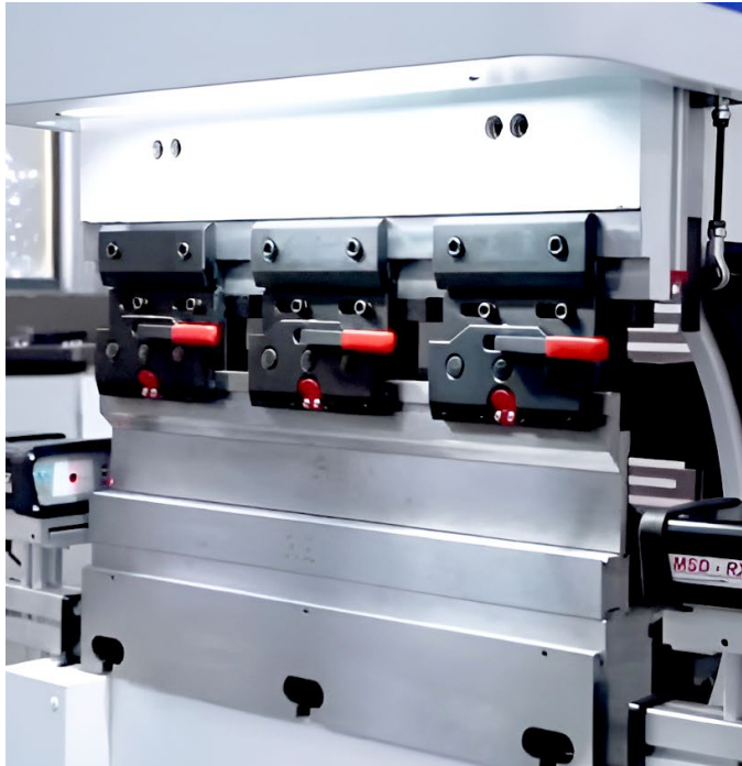
Portaherramientas tipo europeo con sujeción manual y cambio rápido.
