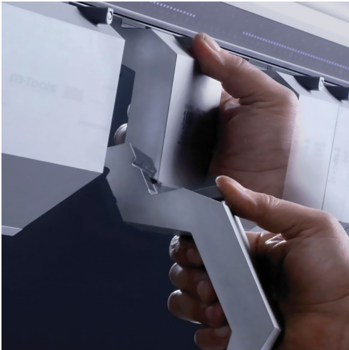
Herramientas adicionales tipo Wila American de alta precisión con botones de seguridad para carga/descarga frontal
