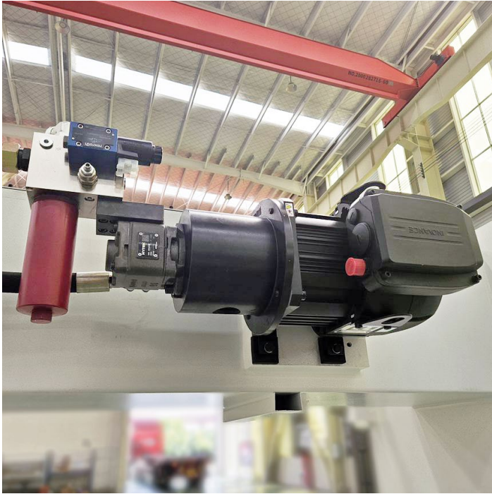
Motor principal servo. Funciona únicamente cuando se requiere (durante el ciclo de doblez). Equipo Estándar en Serie ServoPro y ServoMaster
