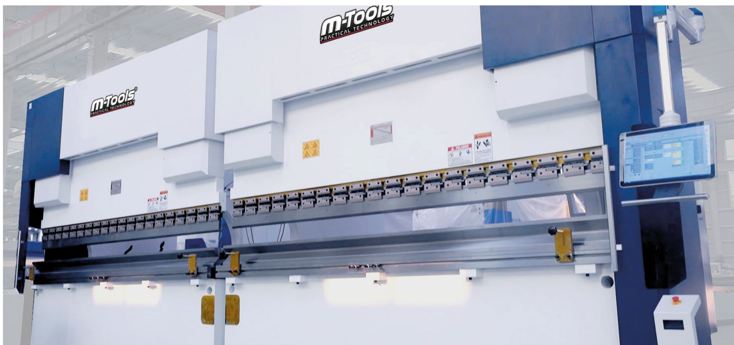
Preparación para instalación en tándem o tridem. Permite trabajar dos o tres máquinas simultáneamente para doblar piezas largas, o trabajar cada máquina independientemente para doblar piezas de menor largo
