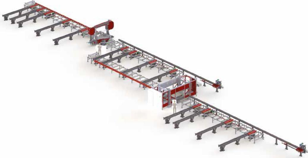
3 ADM'de üç ayrı bağımsız spindle ünitesi sayesinde profilin üç tarafına aynı anda delik delinebilir. Her spindle için dört takım kapasiteli takım değiştirme sistemi mevcuttur.
