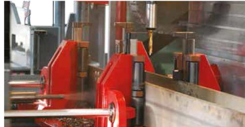
**AKYAPAK**, sektörünün öncüsü olarak çelik konstrüksiyon delik delme hatlarında da teknolojisini Türkiye' den dünyaya taşıyor. Bu alanda **AKDRILL** markasını oluşturan **AKYAPAK**, çelik konstrüksiyon direkler için servo motorlu CNC delik delme makine serilerini **ADM** ismi ile üretiyor.
