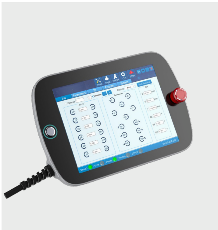
Teach pendant/Unidad de programación (robot industrial).
