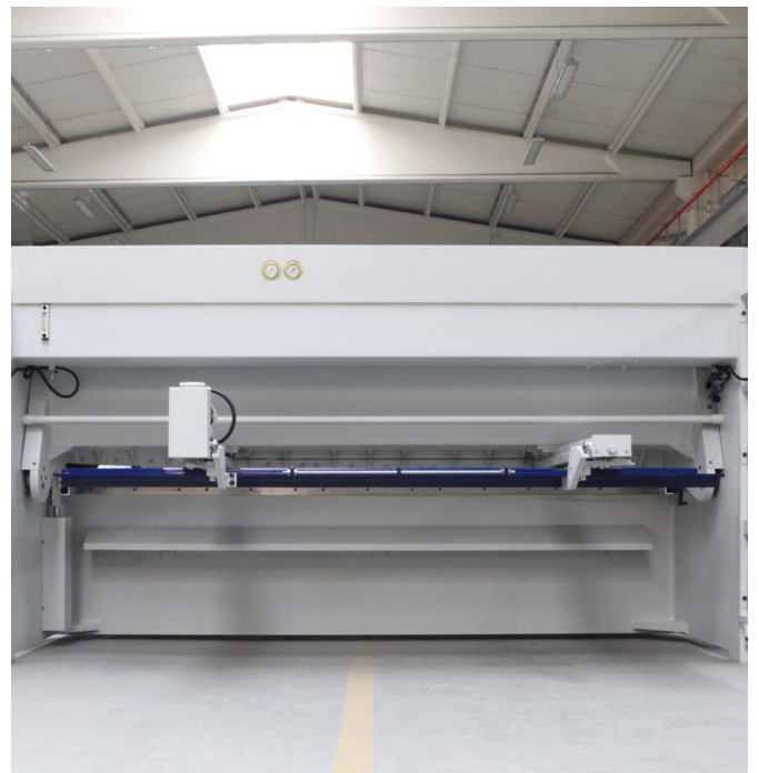
Tope trasero motorizado de 39" (1000 mm) automáticamente abatible
