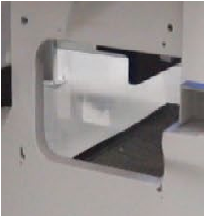
Incremento de garganta a 20" (500 mm) en vez de 10"
