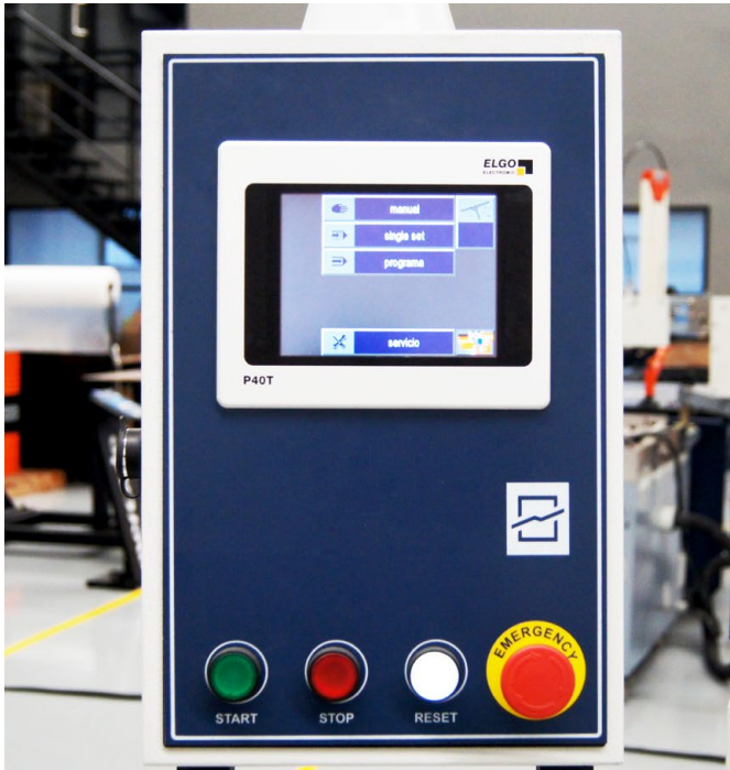
Control numérico con pantalla táctil (touchscreen) de 5.7"
