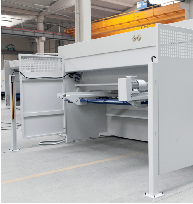
Guardas de seguridad traseras con cortina de luz
