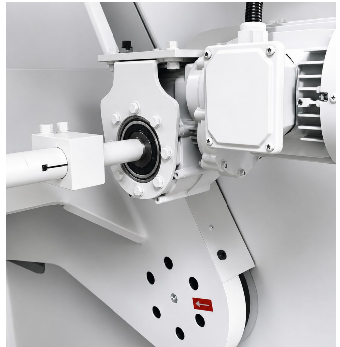
Ajuste motorizado del claro entre cuchilla. Ajustable desde el panel de control (Estandar en Optima Plus)
