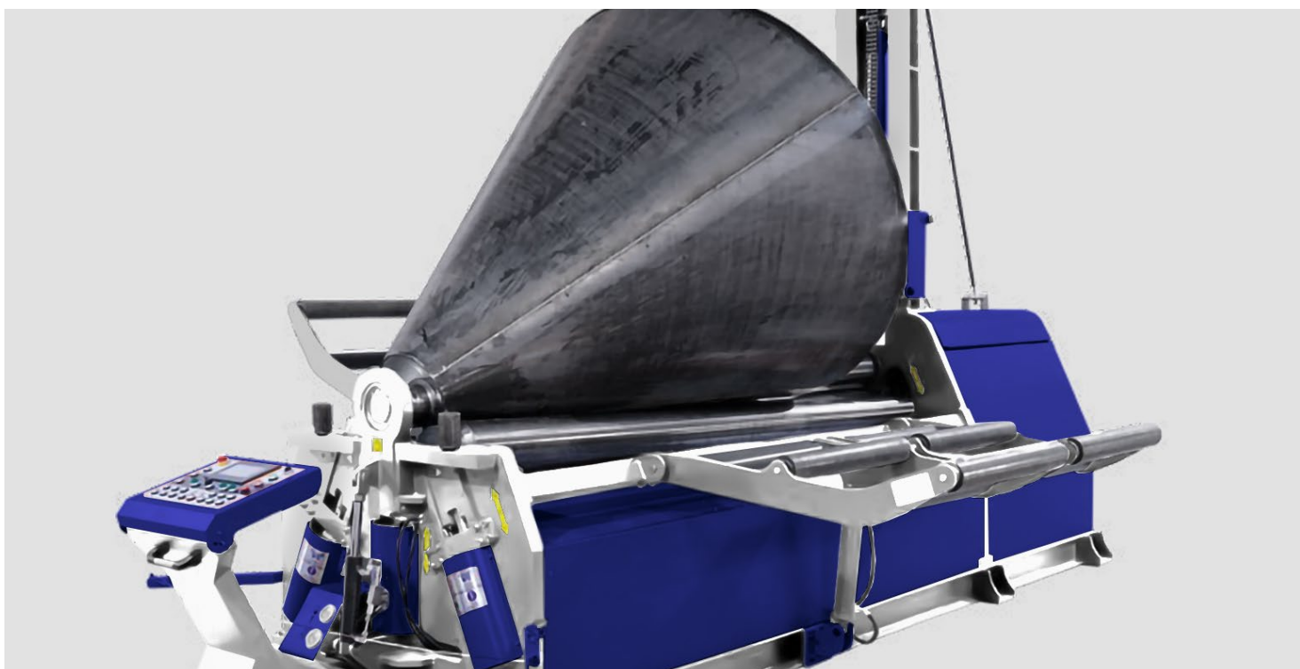
Sistema para rolar conos con operación desde el control
