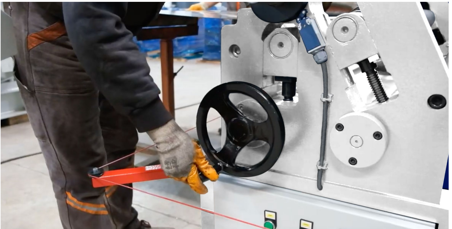
Apertura manual del rodillo superior para extraer las piezas roladas.
