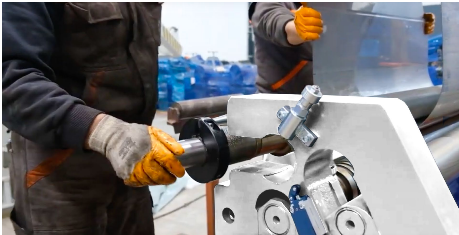
El rodillo superior se abre manualmente para extraer las piezas roladas.
