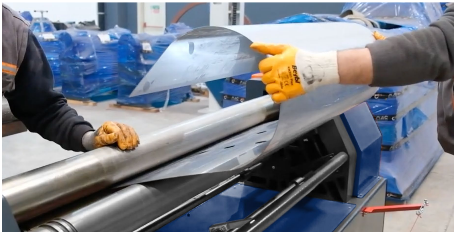
Ajuste motorizado del rodillo trasero (lateral).
