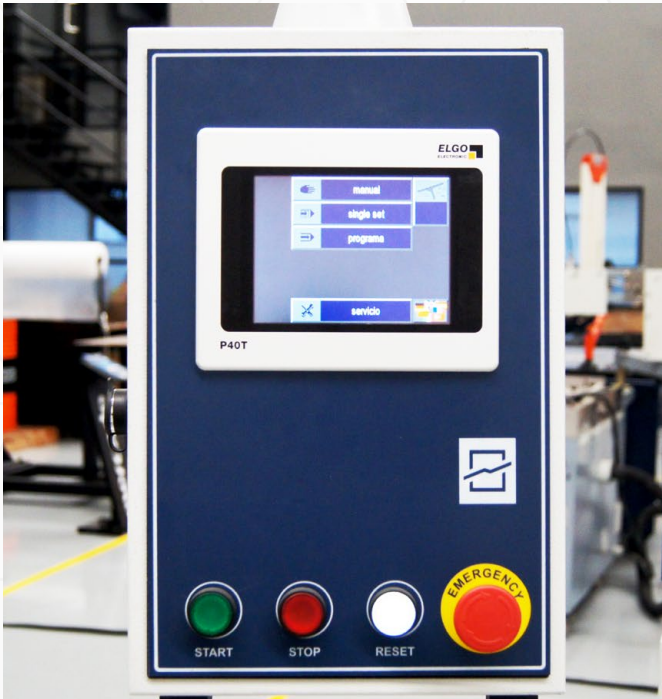
Control numérico con pantalla táctil (touchscreen) de 5.7"
