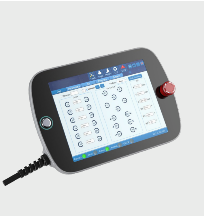
Teach pendant/Unidad de programación. (robot industrial).
