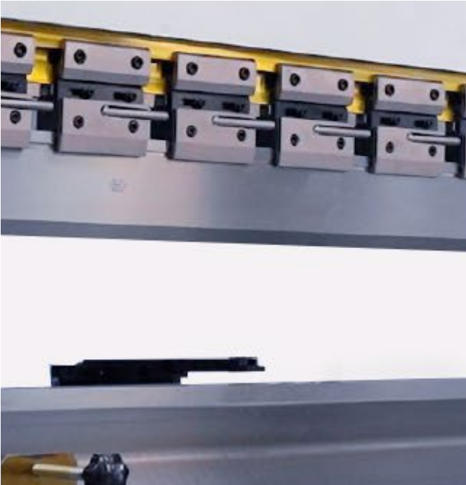
Portaherramientas superior tipo europeo con sujeción manual y carga lateral. Sin costo.
