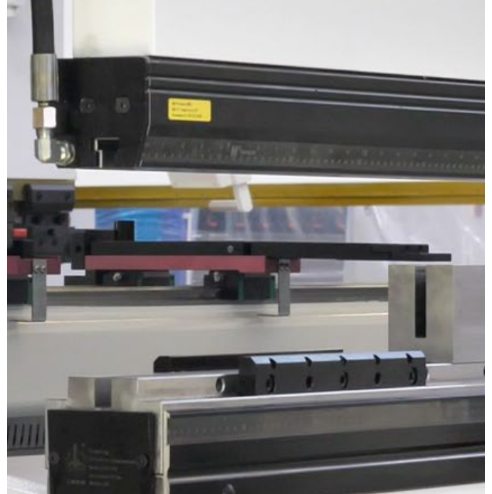
Portaherramientas superior tipo Wila con sujeción hidráulica.
