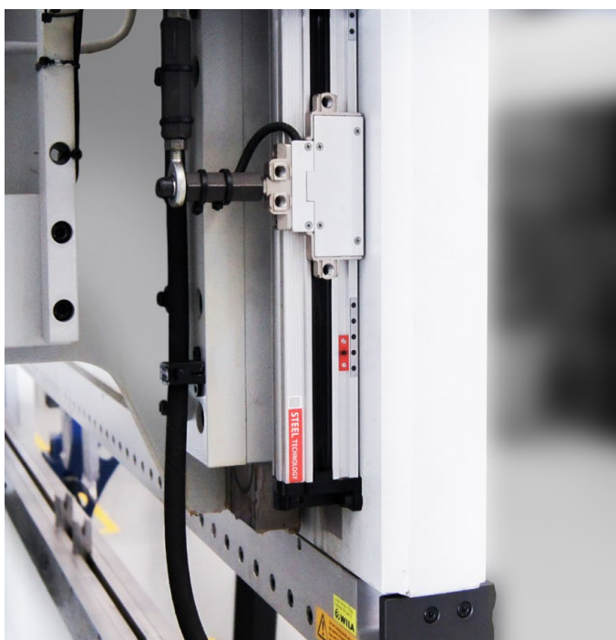
Escalas lineales magnéticas con alto grado de precisión ( \pm 0.0001'' ), Heidenhan, Alemania.
