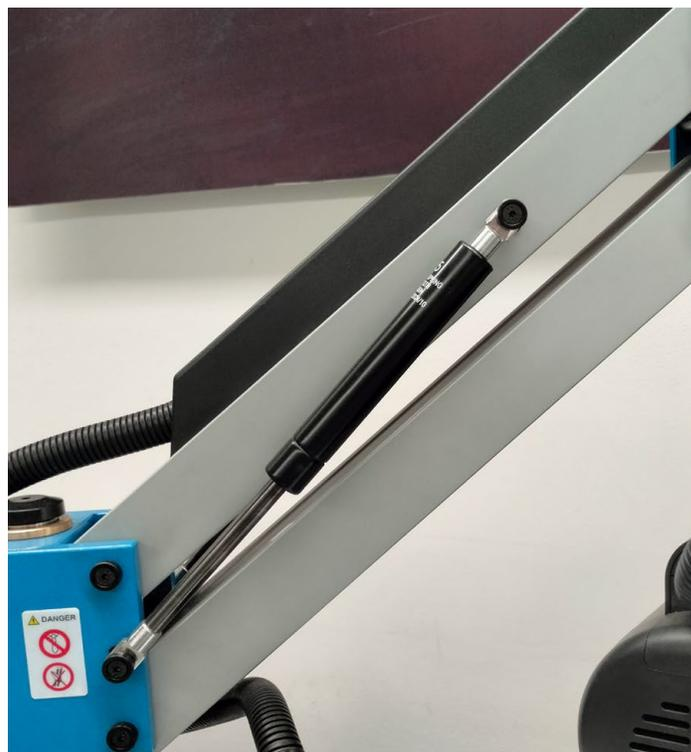
2 pistones neumáticos ajustables para mantener el balance del brazo.
